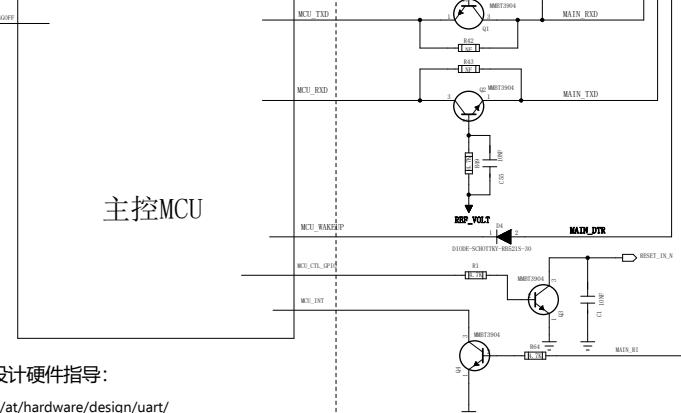
Air780EEN/EEU/EEJ模块串口设计硬件指导：
