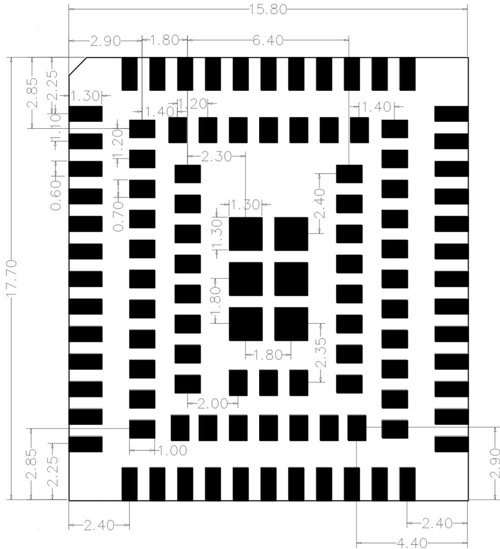
正视图，Air780EG PCB 封装（单位：毫米）
