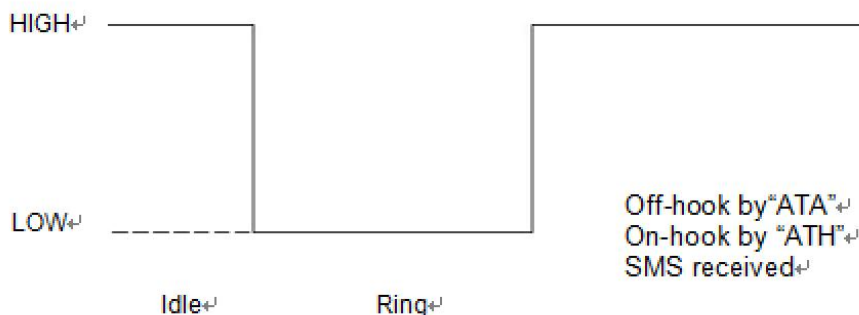
图表 15: 语音呼叫时模块用作被叫方 MAIN_RI 时序
